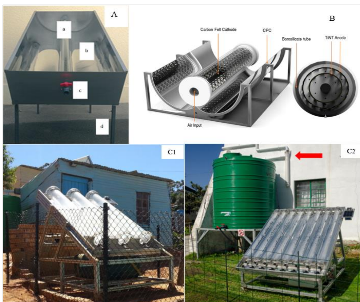
Figura 29 - Configurações das tecnologias de tratamento de água de chuva usando a energia solar e também combinações com outras tecnologias
