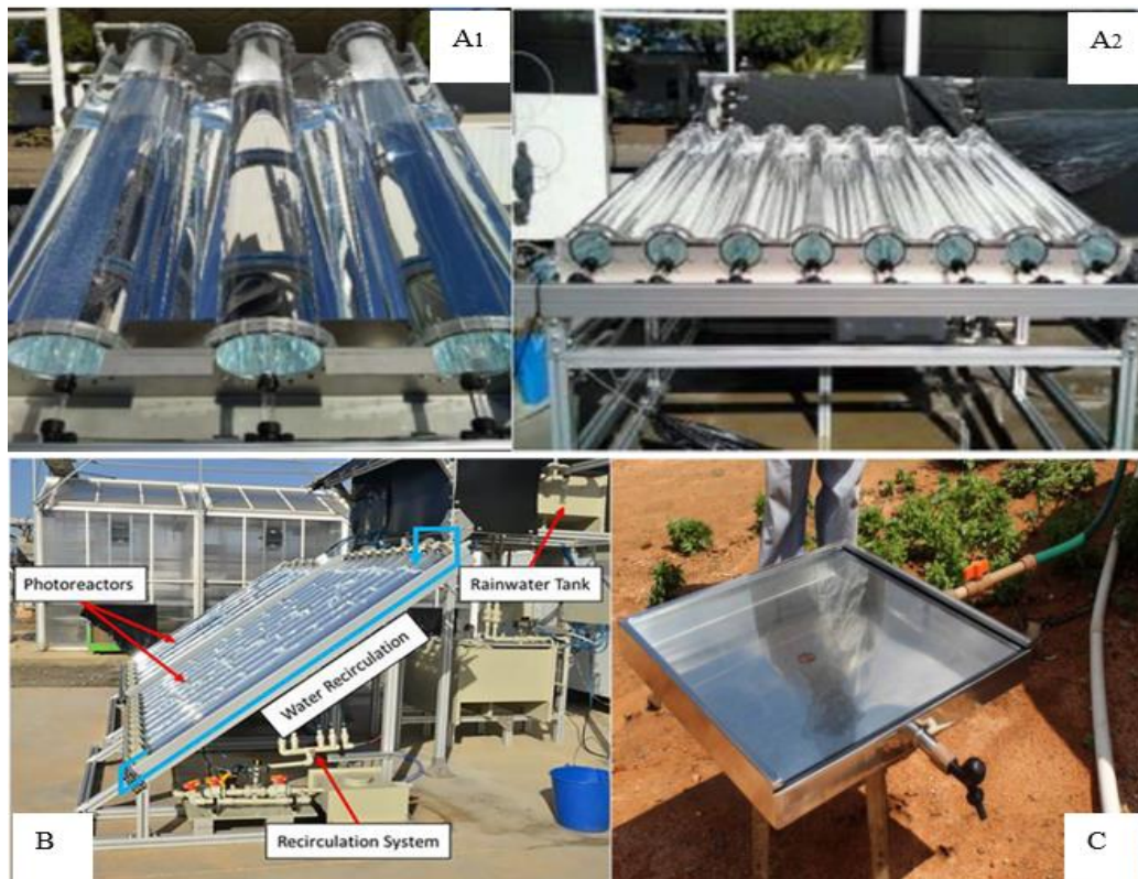
Figura 27 - Configurações das tecnologias de tratamento de água de chuva usando a energia solar e também combinações com outras tecnologias
